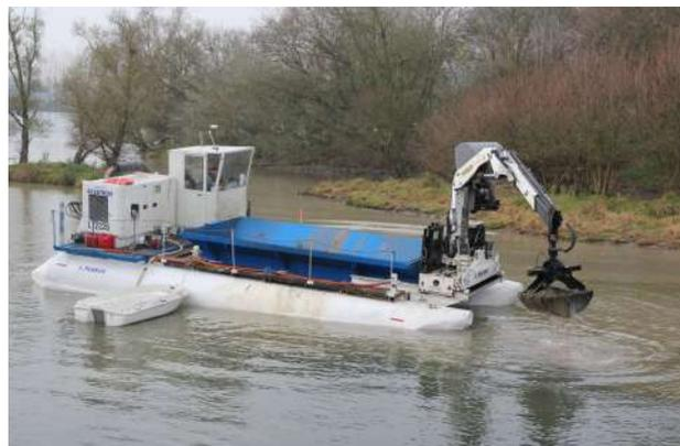
Barge munie d'une pelle mécanique creusant le lit de la rivière. Un nouveau curage avec cet engin est envisagé en cas d'accumulation excessive des sédiments. Le choix sera guidé par les résultats d'un suivi de plusieurs années de la profondeur du bras secondaire de la Saône.
