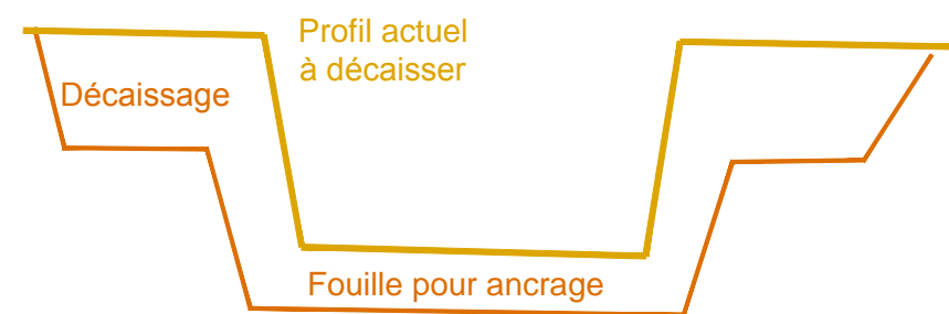
Fond de forme pour ancrage vue de face
